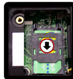
Abb. 10 - Schließen des SIMLOCK-Riegels
